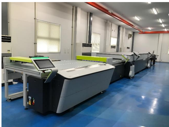
CrystalCleanConnect, la première solution au monde de confection de plaques flexographiques entièrement automatisée, fruit d'une collaboration d'Asahi Photoproducts et d'ESKO
