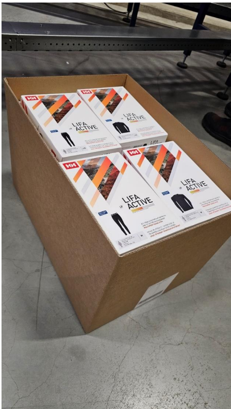
La hauteur des caisses emballées est automatiquement réduite pour s'adapter au contenu au moyen du Cut it! EVO de Ranpak Automation, offrant une quantité d'air réduite, un plus grand nombre de cartons par palette et moins de camions sur la route
