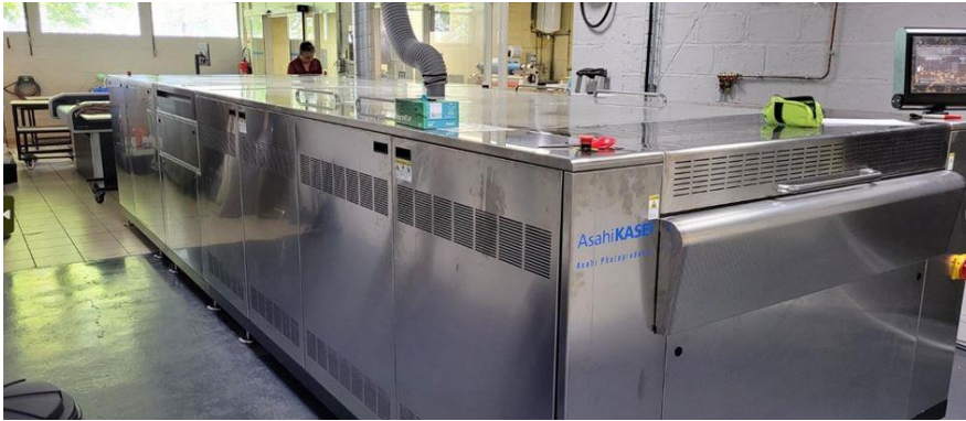
Bildunterschrift: Der bei der Imprimerie Floch, Frankreich, installierte Inline-Prozessor AWP™ 4260 PLF von Asahi.
