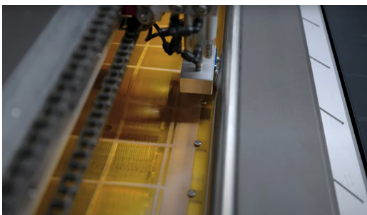
Der Inline-Schneidetisch der CrystalCleanConnect hilft automatisiert, den Plattenabfall auf ein minimum zu reduzieren.
