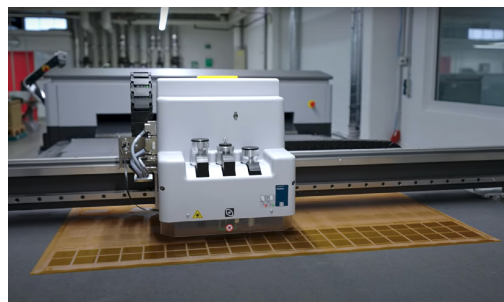
Der Inline-Schneidetisch der CrystalCleanConnect hilft automatisiert, den Plattenabfall auf ein minimum zu reduzieren.
